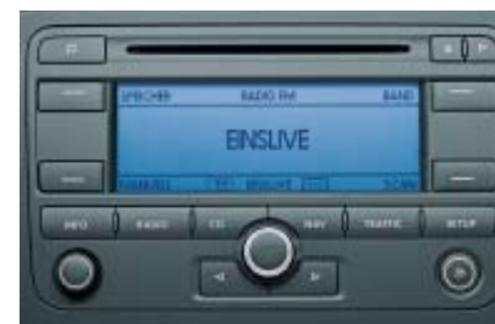
Das optionale **Radio-Navigationssystem „RNS 300“** verfügt über ein monochromes Display und insgesamt acht Lautsprecher vorn und hinten. Bei inaktiver Zielführung kann das System auch als CD-Player genutzt werden.
