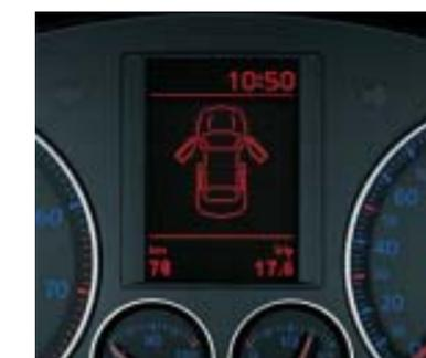
Die optionale **Multifunktionsanzeige „Plus“** informiert Sie über Fahrinformationen wie Durchschnittsgeschwindigkeit, Außentemperatur, die Uhrzeit und den momentanen bzw. durchschnittlichen Kraftstoffverbrauch.
