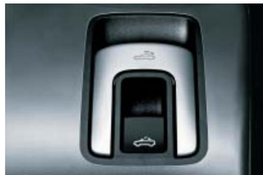
Die Schalter zur Steuerung des vollautomatischen CSC-Dachsystems sowie des Schiebe-/Ausstell-Glasdachs sind in die Mittelkonsole integriert.
