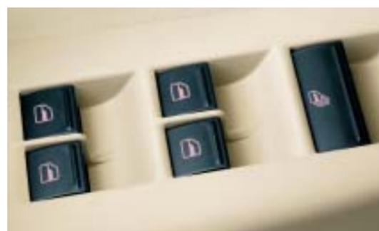
Die **elektrischen Fensterheber vorn und hinten**, die durch einmaliges Antippen die Scheiben komplett versenken oder hochfahren.
