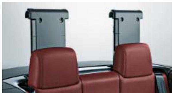
Das **aktive Überschlagschutz-System** wird im Falle eines Überschlags innerhalb von Sekundenbruchteilen vollautomatisch ausgefahren und schützt alle Passagiere bestmöglich.
